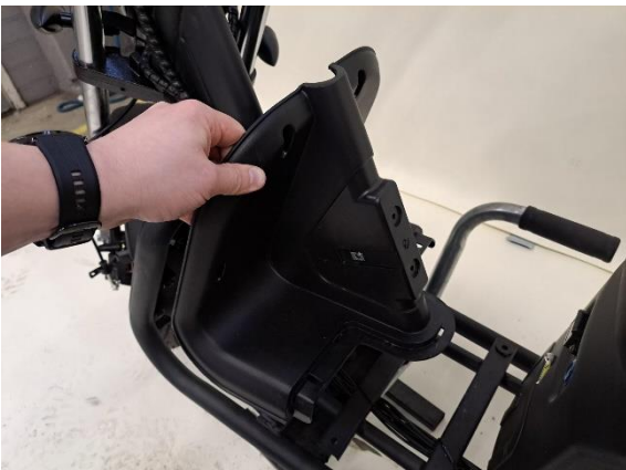
Ota jalkatilan etuosan muovi pois.
