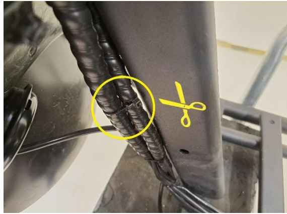
Katko kaikki kaasukahvan johtoja kiinni pitävät nippusiteet (sivuleikkurit).
